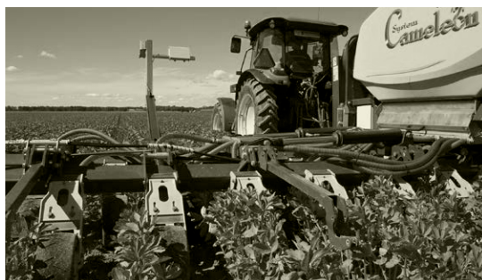
Figur 3: Gothia Redskaps System Cameleon kan rensa ogräs genom kameror som ser vad som är ogräs och vad som är gröda.
